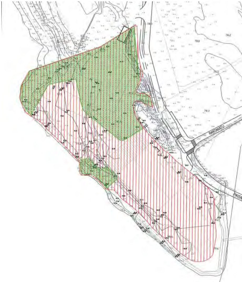
Kuva 1. Vuonna 2002 kunnostettu alue ja maaperän PCDD/F – pitoisuudet. Vihreät alueet pi- toisuudet yli Samase raja-arvon; punainen viivoitus, pitoisuudet yli Samase ohjearvon (Ristola, 2003).
